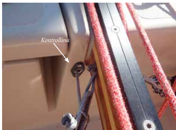
Bild 4. Kontrollinan kommer ut från kistan akter om storskotsbalken.
