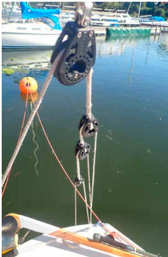
Bild 1. Akterstaget på Primula har en kaskadlösning med 16 gångers utväxling och kontrollinan går rakt ner under däck.
