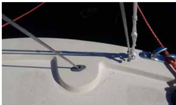
Bild 2. Kontrollinans genomföring sedd ovanifrån.
