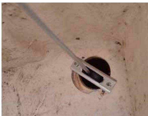
Bild 3. Underifrån, inifrån akterstuvens, linan går via ett styrblock vidare igenom skottet mellan akterstuvens och in i överkant av babords kista där det bryter igen i ett block i övre delen av kistans förliga skott mot babords stick.
