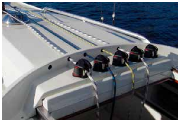
Drar ner trim som kick, uthal, upphal till spinnakerbom, alla fall och cunningham. De är här framdragna genom sargen för sprayhooden så de går att nå från sittbrunnen.
