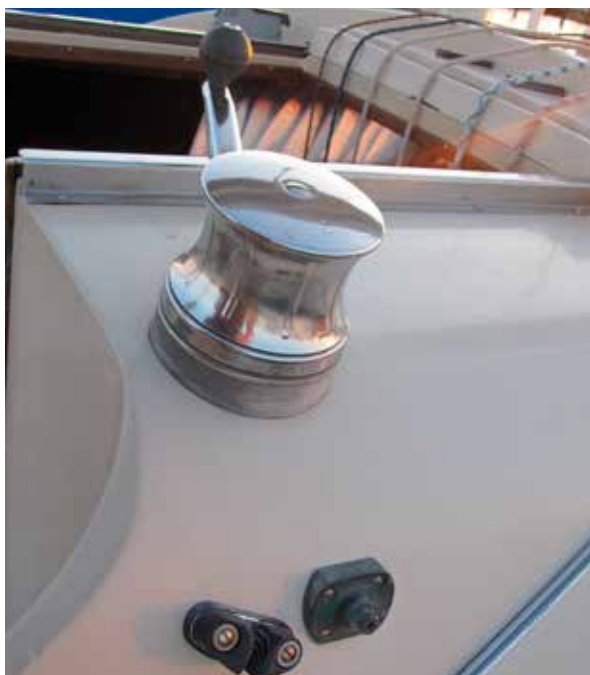
Underdragna Andersen vinschar på rufftaket underlättar betydligt vid skotning av genuan. Läs hela tråden om hur Johan Winberg renoverat sin IF till toppskick på http://ifboat.se/forum/21/890#p3666 .
